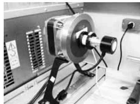
Figura 9 – Motor após os testes de cálculo do momento de inércia
